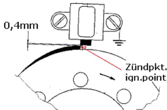
Nach Einstellung, Befestigen Sie die beiden Halteschrauben des Sensors sorgfältig !!
