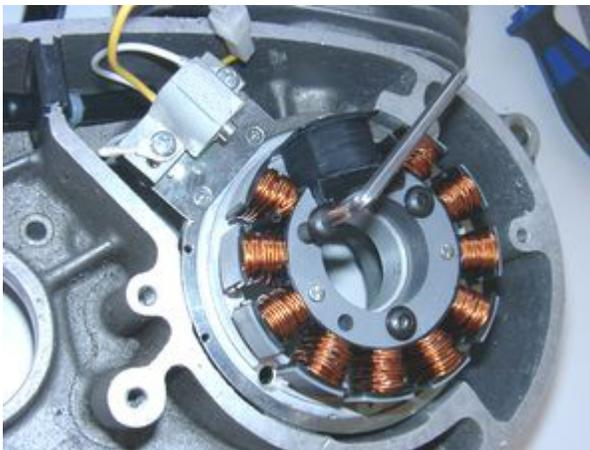
Setzen Sie den Spulenkörper wieder auf die Platte, so dass die Kabel sauber durch die Plattenöffnung gehen können und nicht eingeklemmt werden.
