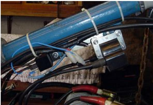
Befestigen sie die neue elektronische Zündspule an der Stelle, an der die alte Zündspule war.
