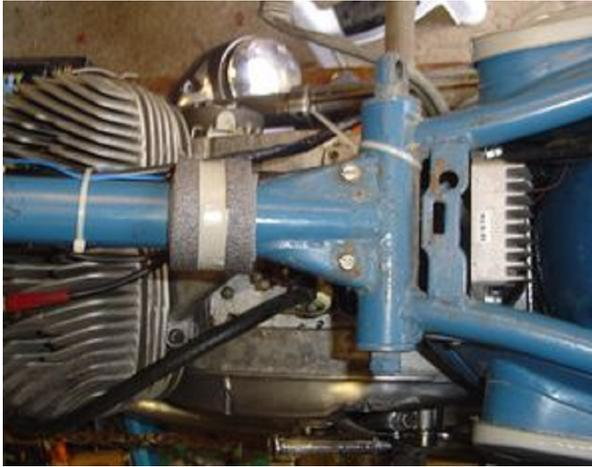
Befestigen sie den elektronischen Gleichrichter/Regler an einer geeigneten Stelle.
