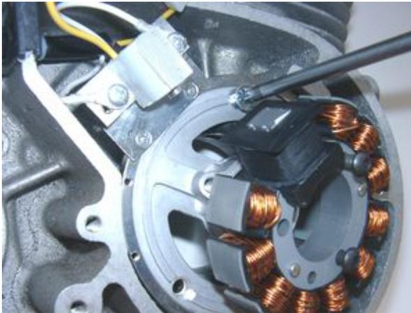
Setzen sie nun die aus zwei Teilen (ein Stahlring und eine Aluminiumplatte) bestehende Statorplatte anstelle der früheren Lichtmaschine auf das Kurbelgehäuse.
