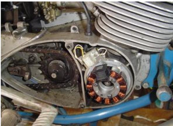
Montierter neuer Stator.
